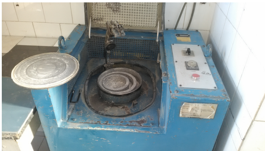
Slika 6. Vibracioni prstenasti mlin, KHD, Humboldt Wedag, AG
